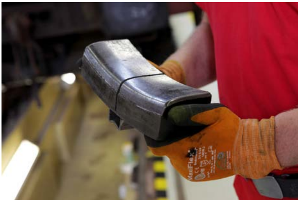
Abbildung 54: Beispiel einer LL-Bremssohle.
