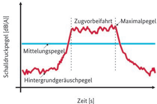
Abbildung 04: Grafische Darstellung des Zusammenhanges zwischen dem Schalldruckpegel und dem Mittelungspegel am Beispiel einer Zugvorbeifahrt.
